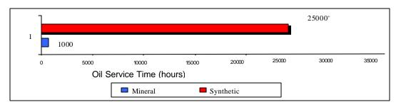
Fig. 8 (Compressor Lube)
